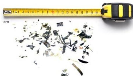
B油底壳滤网上的金属碎屑
